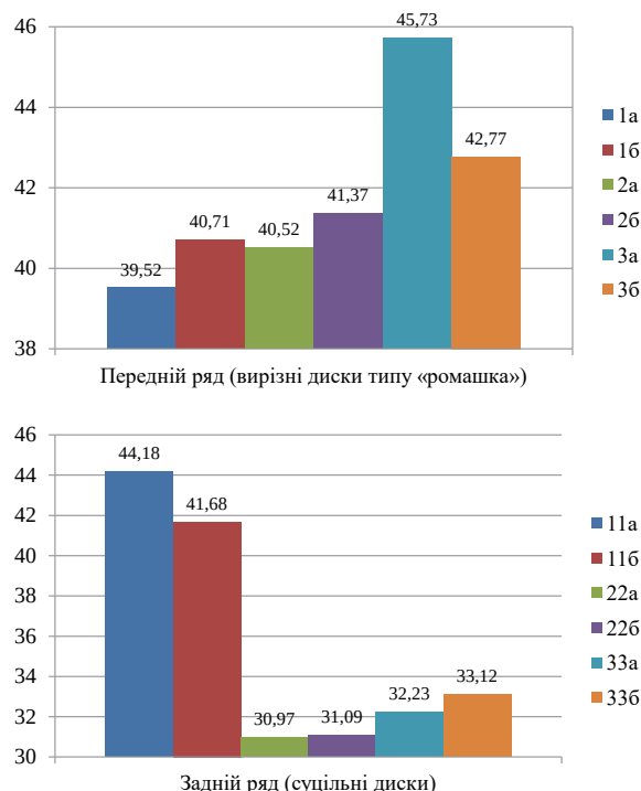
Рис. 3. Зміна твердості поверхні дискового робочого органу виготовленого зі сталі 65Г: 1a, 11a, та 16, 116 – зовнішня та внутрішня сторона диска відповідно експлуатуються на легкій глині; 2a, 22a та 26, 226 – зовнішня та внутрішня сторона диска відповідно експлуатуються на середньому суглинку; 3a, 33a та 36, 336 – зовнішня та внутрішня сторона диска відповідно експлуатуються на супіщаному ґрунті
